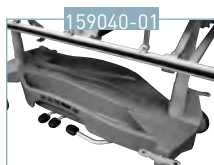
159040-01 Carter amovible porte-bouteille oxygène (dim. D, E, F) Removable oxygen bottle holder (dim. D, E, F)
